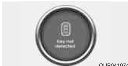
Если смарт-ключ не находится в транспортном средстве или не обнаружен, при нажатии кнопки запуска/остановки двигателя на ЖК-экране в течение 10 секунд будет высвечиваться это предупреждение. Кроме того, индикатор иммобилайзера будет гореть в течение 10 с.
