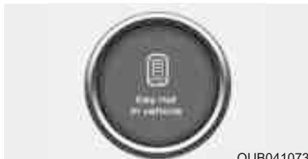
Если электронный ключ не находится в транспортном средстве и если какая-нибудь дверь открыта или закрыта, когда ключ зажигания находится в положении ACC, ON или START, на ЖК-экране высвечивается предупреждение. В течение 5 секунд подается звуковой сигнал, когда смарт-ключ не находится в транспортном средстве и закрыта любая дверь.
