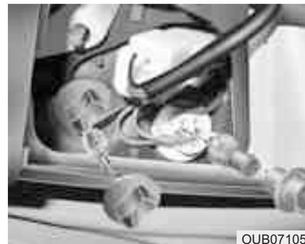
4. Извлеките патрон из блок-фары, провернув его против часовой стрелки до совмещения выступов на патроне с прорезями блок-фары.
