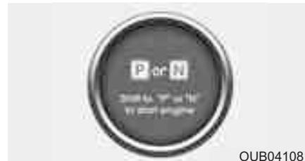
Если попытаться запустить двигатель, когда рычаг переключения передач не установлен в положение P (парковка) или N (нейтраль), на ЖК-экране в течение 10 секунд будет высвечиваться это предупреждение.
