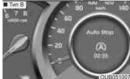
Двигатель остановится, и загорится зеленый индикатор AUTO STOP (автоматический останов) (A) на комбинации приборов. Если автомобиль оснащен оптической приборной панелью, на ЖК дисплее отобразится сообщение.
