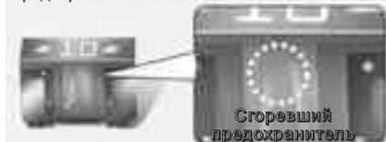
Предохранитель патронного типа
