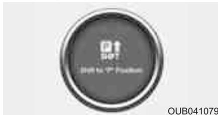
При попытке выключить двигатель, не установив рычаг переключения передач в положение P (Парковка), кнопка engine start/stop перейдет в положение ACC. При повторном нажатии на кнопку она перейдет в положение ON (Вкл.). В течение 10 сек на ЖК экране будет показано предупредительное сообщение, указывающее на то, что нужно нажать на кнопку engine start/stop переведя рычаг в положение P (Парковка) для отключения двигателя.
