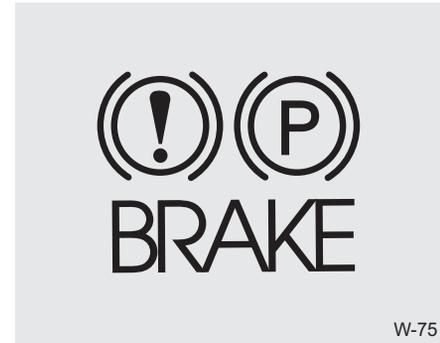
Проверьте контрольную лампу тормоза поворотом ключа зажигания в положение ON (Вкл.) (но не запускайте двигатель). При включенном стояночном тормозе и ключе зажигания в положении START (Запуск) или ON (Вкл.) эта лампа должна гореть.
