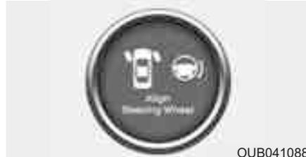
Если вы запустите двигатель в то время, когда рулевое колесо повернуто на 90 влево, через пару секунд на ЖК дисплее на 5 секунд загорится сообщение “Выровняйте рулевое колесо”.
