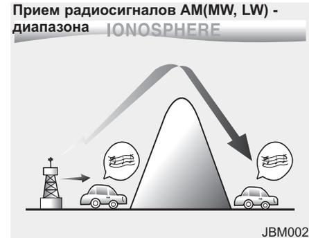
Сигналы AM(MW, LW)-диапазона могут приниматься на большем удалении от радиостанции, чем сигналы FM-диапазона. Это возможно за счет более низкой частоты радиоволн AM-диапазона. Эти радиосигналы с большой длиной волны и низкой частотой распространяются не по прямой линии в атмосфере, а могут огибать земную поверхность. Кроме того, они огибают препятствующие их распространению объекты, что обеспечивает лучший прием сигнала.
