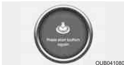
Если не возможно использовать кнопку engine start/stop, неисправна система кнопки engine start/stop. В течении 10 секунд на экране будет показано предупреждение и непрерывно будет звучать звуковой сигнал, указывающие на то, что невозможно запустить двигатель, нажав еще раз на кнопку start/stop.
