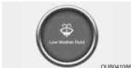
Эта сигнальная лампа высвечивает в течение 10 секунд, если бачок омывателя почти пуст. При нажатии на кнопку TRIP во время горения предупредительной сигнализации, режим ЖК дисплея на 4 секунды переходит в режим поездки и затем вернется в режим малого количества жидкости стеклоомывателя. Необходимо залить жидкость для стеклоомывателя при первой возможности.
