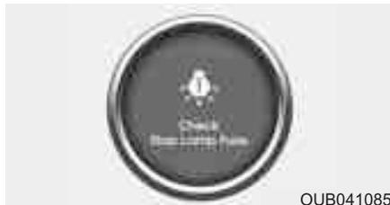
Если отключен предохранитель стоп-сигнала, на ЖК дисплее на 10 сек загорается предупреждение.
