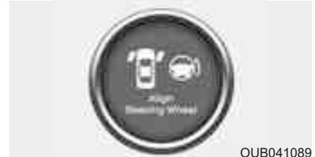
Если вы запустите двигатель в то время, когда рулевое колесо повернуто на 90 влево, через пару секунд на ЖК дисплее на 5 секунд загорится сообщение “Выровняйте рулевое колесо”.
