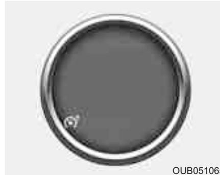
Чтобы ехать со скоростью, больше установленной ограничением скорости нужно жестко нажать на педаль газа (на 80% больше, чем обычно) до срабатывания механизма отдачи со щелчком. Затем начнет мигать индикатор ограничения скорости и будет звучать сигнал до тех пор, пока скорость автомобиля вернется в рамки ограничений скорости.
