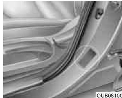
На табличке сертификации автомобиля (которая находится на средней стойке со стороны водителя или пассажира) имеется идентификационный номер автомобиля (VIN).
