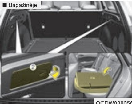
3. Užpakalinė kraštinė sédynė: patraukite užrakto atlaisvinimo svirtelę (1) ir palenkite bei nuleiskite žemyn.
